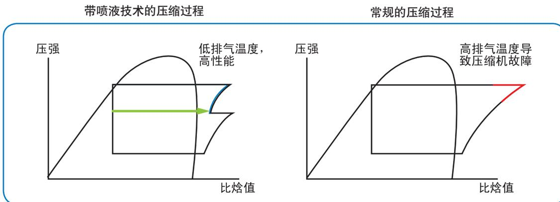
相较于常规压缩过程,喷液技术极大提升低温应用下涡旋压缩机的可靠性
