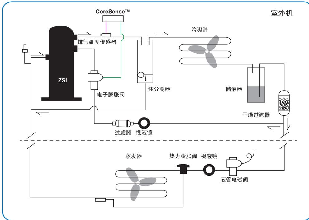
CoreSense模块精确控制喷液量
